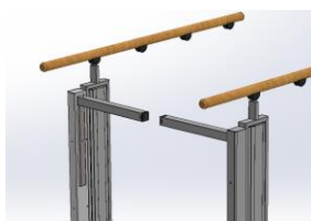
2 pav. Automatiniai platformos užtvapai (atskirai užsakoma įranga) pakeliami ir užfiksuojami
